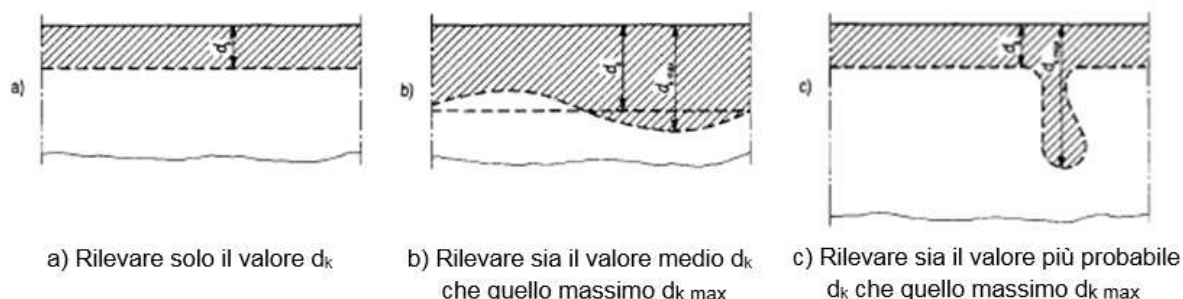
Figura 42 - Schema misura carbonatazione
