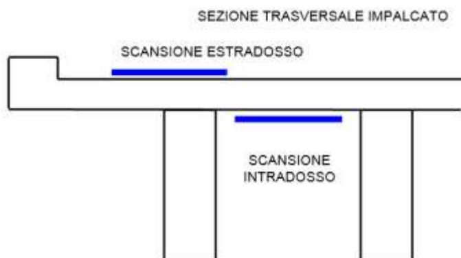
Figura 28 - Rilievi principali delle barre di armatura delle solette
