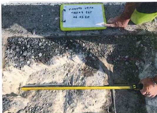
Figura 8 – Esempio di restituzione- Determinazione spessore pavimentazione stradale
