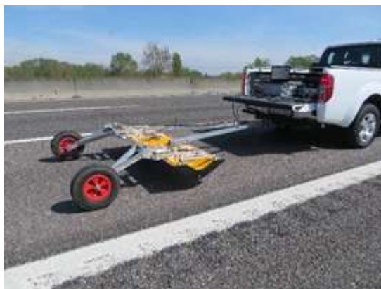
Figura 9 –Determinazione spessore pavimentazione stradale da piattaforma stradale
