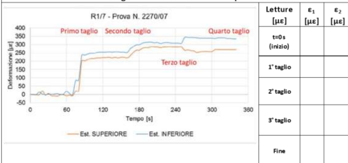
Figura 64 – Esempio scheda di restituzione – Rilascio Tensionale sul Calcestruzzo – Metodo Sectioning
